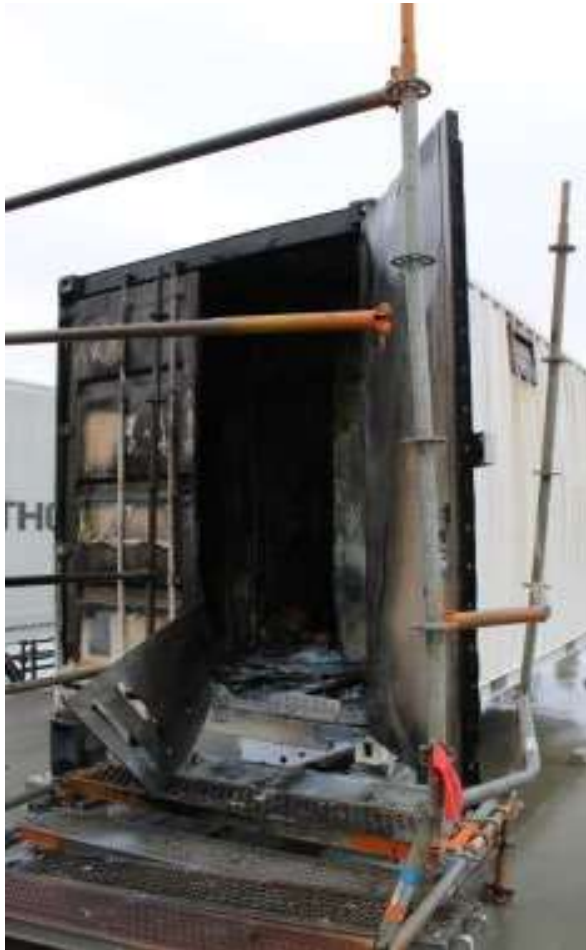
Fig. 2 : De explosie van de container werd veroorzaakt door de ophoping van explosieve ontledingassen, gevolgd door hun ontsteking.
