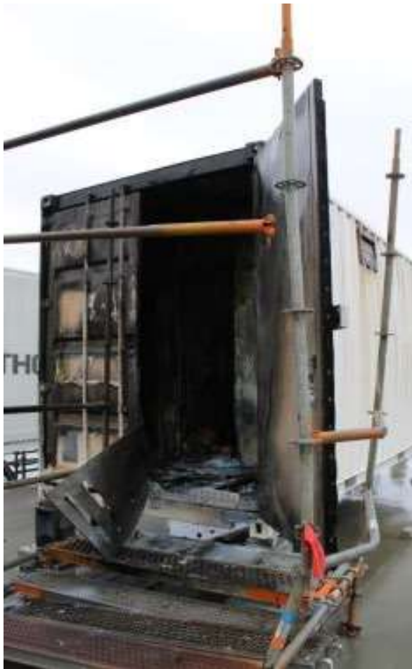
Fig. 2 : L'explosion du conteneur a été provoquée par l'accumulation de gaz de décomposition explosifs, suivie de leur ignition.
