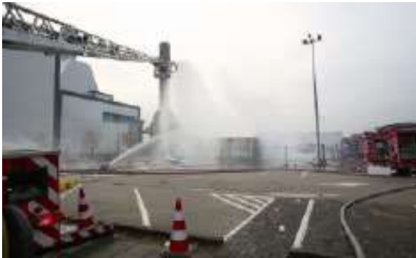
Fig. 3 : Lance-moniteur mise en place et arrosage à haut débit.
